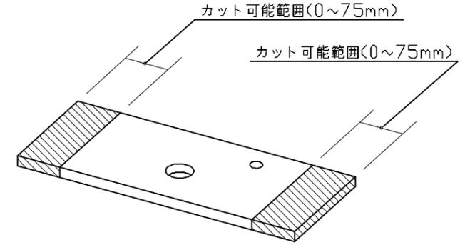
カット側の木口面は必ず壁側に設置してください。
