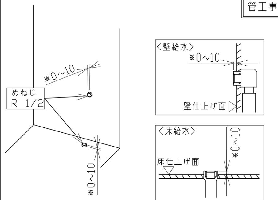
※設備側給水管の取り出し出面は、床・壁仕上げ面から0~+10mm以内としてください。
