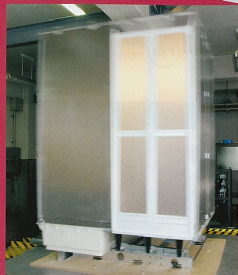
▲タカラシステムバス耐震実験の様子です。 (実験は、関西電力株式会社 電力技術研究所の振動実験装置を用いて行いました。)
