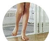
フラット洗い場 浴室と脱衣所の段差が3mmに。つまずきなど、足元の不安感を軽減。
