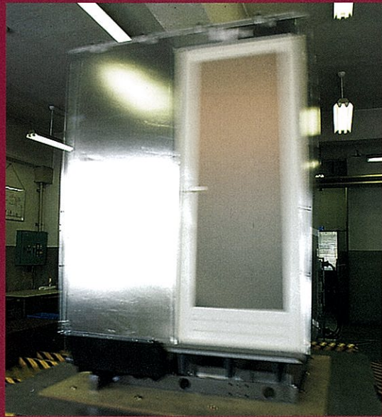
▲写真はタカラシステムバス耐震実験の様子です。
