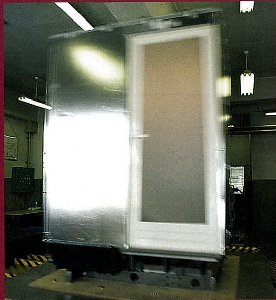
▲タカラシステムバス耐震実験の様子です。(実験は、関西電力株式会社 電力技術研究所の振動実験装置を用いて行いました。)
