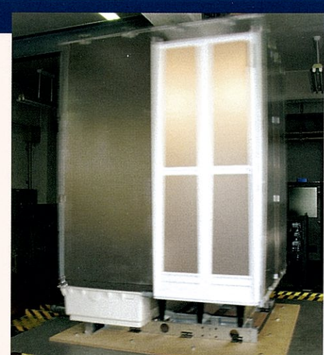
▲タカラシステムバス耐震実験の様子 (実験は、関西電力株式会社 電力技術研究所の振動実験装置を用いて行いました。) 実験条件 ＜実験状況＞ システムバスユニット単体での加振実験(振動台に架台を固定) ＜振動内容＞ 平均加速度:800gal、振動周波数:3~5Hz間で変移の振動(理論上の震度6強)を1分間加振
