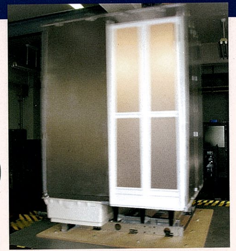
▲タカラシステムバス耐震実験の様子 (実験は、関西電力株式会社 電力技術研究所の振動実験装置を用いて行いました。) <実験状況> システムバスユニット単体での加振実験(振動台に架台を固定) <振動内容> 平均加速度: 800gal、振動周波数: 3~5Hz間で変移の振動(理論上の震度6強)を1分間加振
