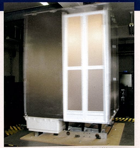
▲タカラシステムバス耐震実験の様子 (実験は、関西電力株式会社 電力技術研究所の振動実験装置を用いて行いました。) <実験状況> システムバスユニット単体での加振実験(振動台に架台を固定) <振動内容> 平均加速度: 800gal、振動周波数: 3~5Hz間で変移の振動(理論上の震度6強)を1分間加振 実験条件
