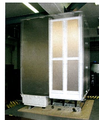
タカラシステムバス耐震実験の様子 (実験は、関西電力株式会社 電力技術研究所の振動実験装置を用いて行いました。)
