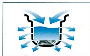
側面にオーバーフローの穴があいているので水の流れがよく、詰まりにくい。
