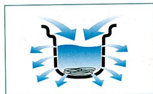
側面にオーバーフローの穴があるので水の流れがよく、詰まりにくい。
