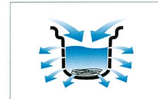
側面にオーバーフローの穴があるので水の流れがよく、詰まりにくい。
