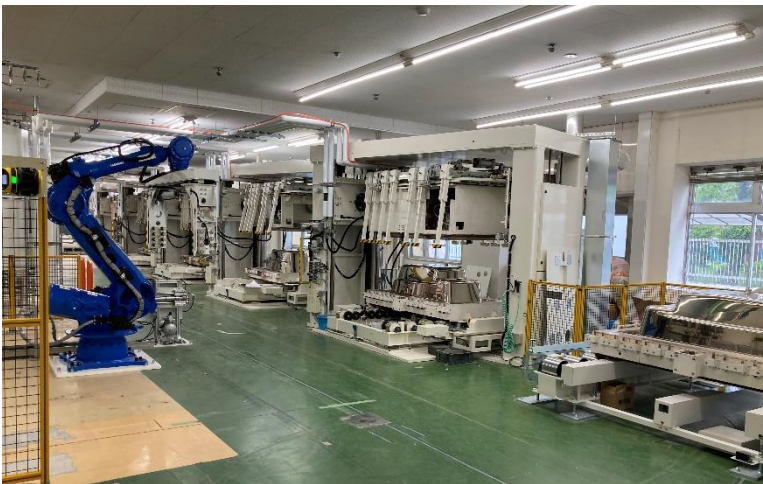
（左：アクリル人造大理石浴槽の製造ライン／右：システムバス「グランSPA」）
