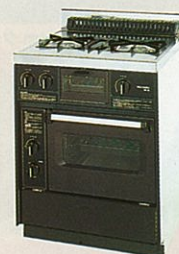
GRF-60B (600×560×800mm) ¥81,000 ●片面換グリル ●半直火式オープン ●サーモスタット ●連続放電式点火 ●立ち消え安全装置付
