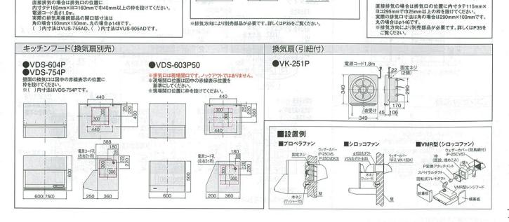
側方排気用 ノックアウト孔 左右2ヶ所
