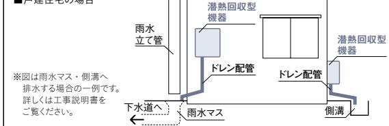
※図は雨水マス・側溝へ排水する場合の一例です。
