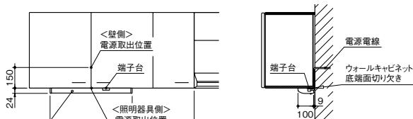
加熱機器より150mm以上離してセットしてください(ただしレンジフード横タイプの下にはセットできません。)
