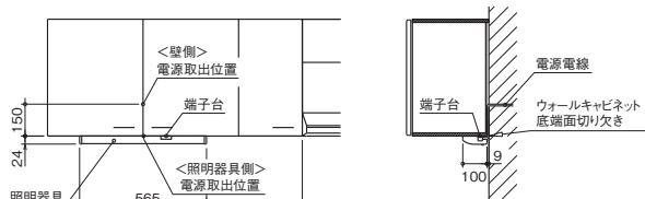
加熱機器より150mm以上離してセットしてください(ただしレンジフード横タイプの下にはセットできません。)
