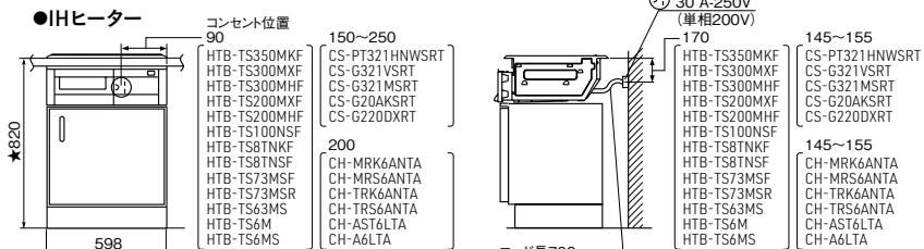
※250V、30Aの埋込コンセントをキャビネット後壁に設けてください。※IHヒーターには200V電源工事が必要です。
