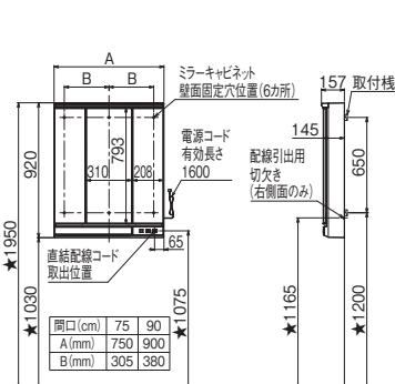
※図に掲載の数値はカウンター高さ80cmの場合の寸法です。★印寸法がカウンター高さ75cmの場合-50mm、カウンター高さ85cmの場合+50mmとなります。※( )内の寸法はショートタイプミラーの場合です。
