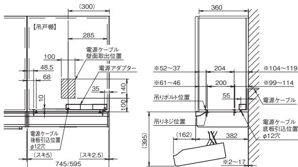
注1)※印の寸法はアイラックの奥行き方向取付位置(額縁出代: 0~15mm以下)によって変動します。
