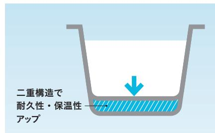
ステンレス自体の特長にプラスして、お湯と人の重みがかかる底部を硬質ウレタンを挟んだ二重底にして補強。耐久性と保温性をダブルで向上しています。
