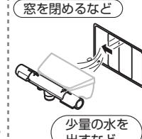
凍結が予想される際は、配管と水栓の水抜き操作を同時にに行ってください。
