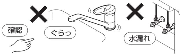
漏水を確認した場合は、止水栓または配管中の元栓を閉めてください。修理の依頼をされる場合は、「保証とアフターサービス」を参照してください。
