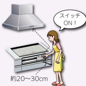
使用中、風量を変える・停止する・照明を切/入する・レンジフードだけを運転する
