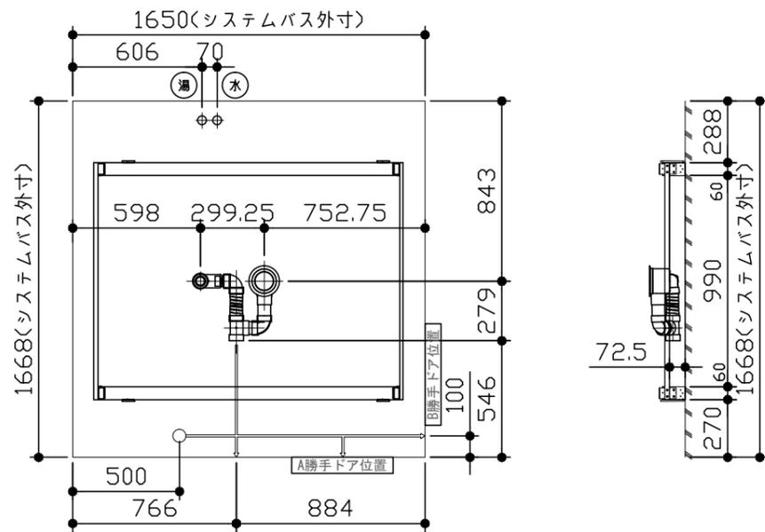
架台・ボルト脚・トラップセット位置図
