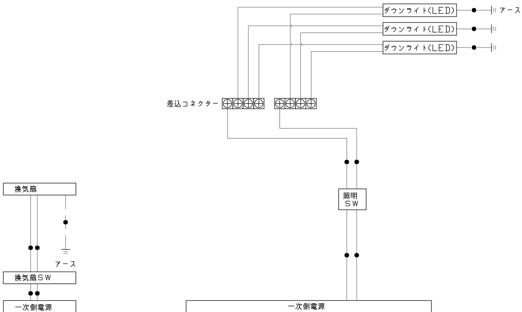
一次側電源から差し込みコネクター及び電源ボックスまでの工事(●部)については、電気設備に関する技術基準及び内線規定に基づき、指定工事業者(電気工事士)による施工が必要です。
