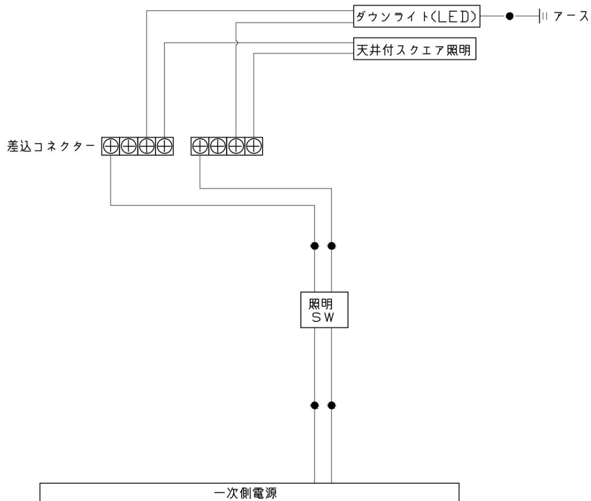
一次側電源から差し込みコネクター及び電源ボックスまでの工事（●部）については、電気設備に関する技術基準及び内線規定に基づき、指定工事業者（電気工事士）による施工が必要です。
