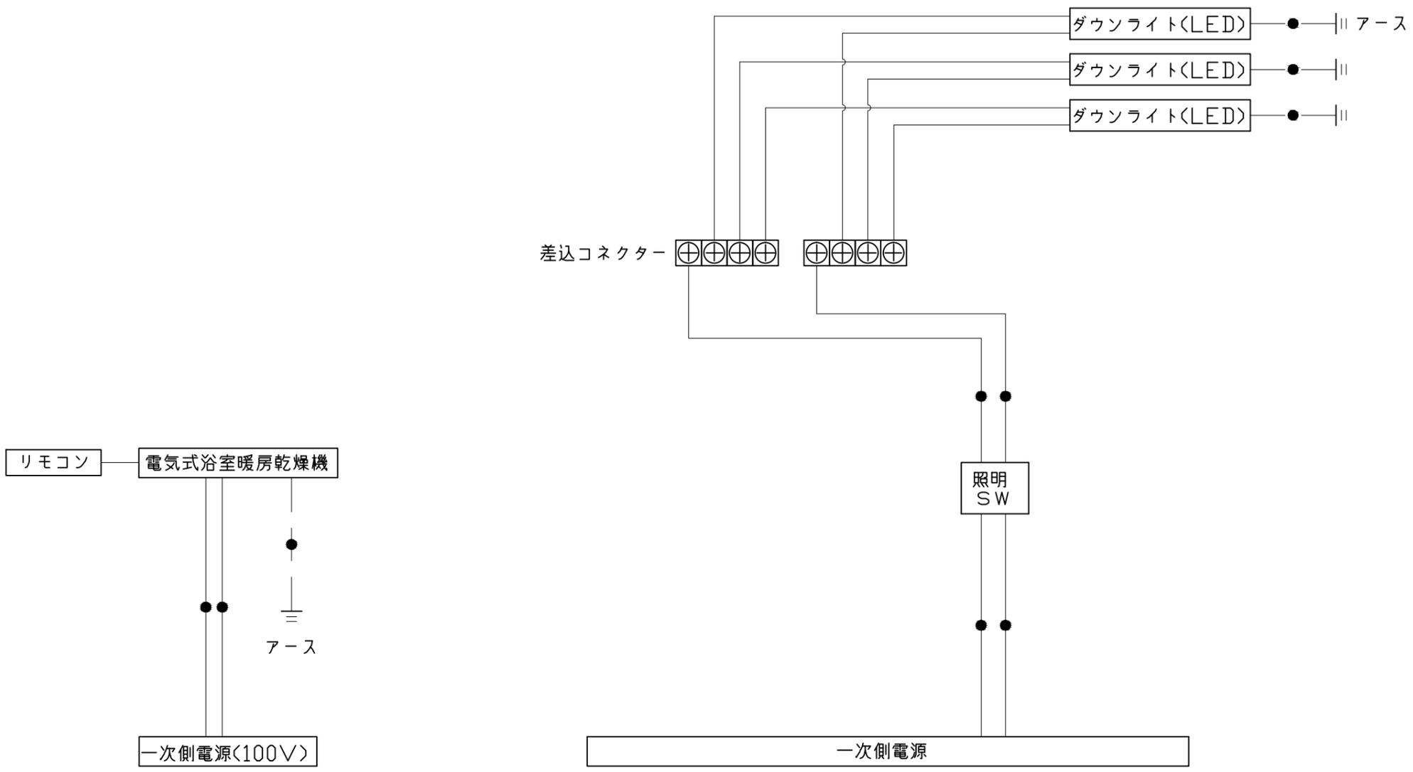
\*浴室暖房機の一次電源には専用のブレーカーを設けてください。
