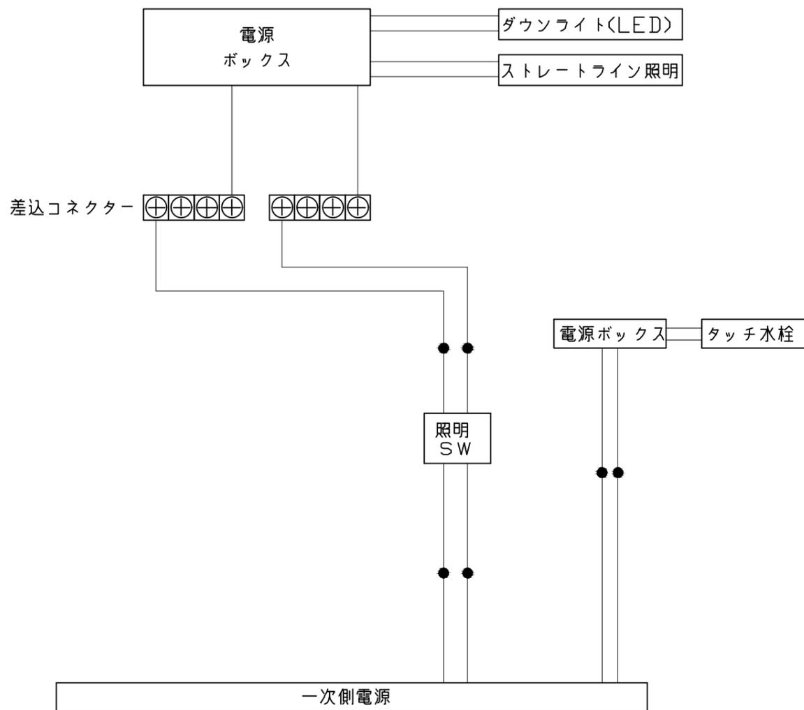
一次側電源から差し込みコネクター及び電源ボックスまでの工事(●部)については、電気設備に関する技術基準及び内線規定に基づき、指定工事業者(電気工事士)による施工が必要です。
