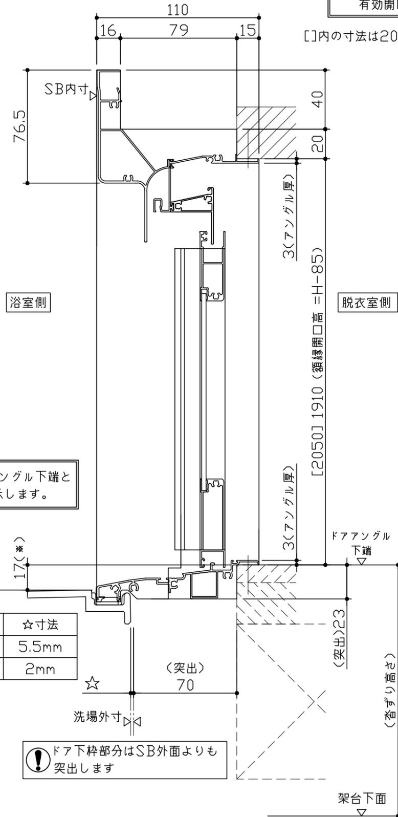
\*印寸法はドアアングル下端とSBFLの段差を示します。
