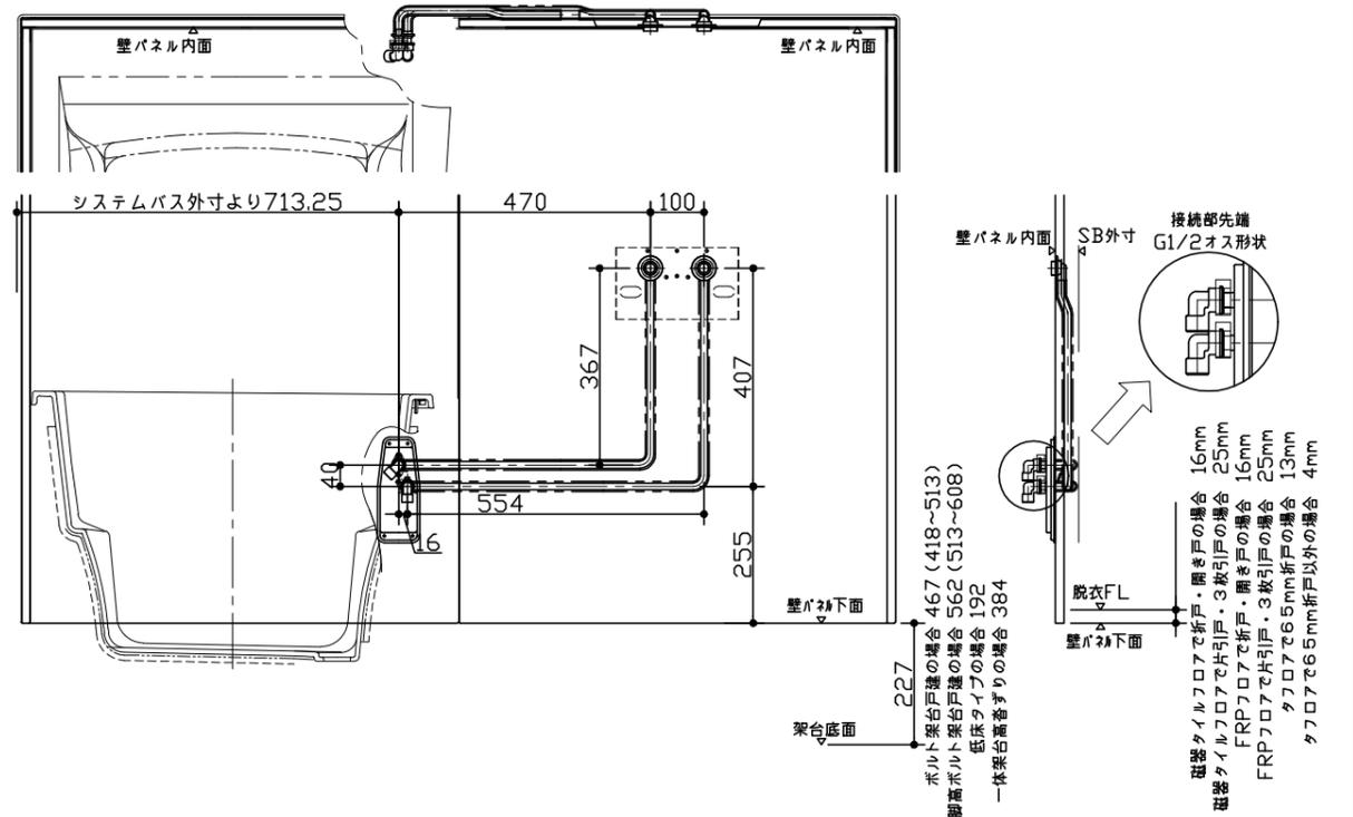
給水給湯管取合詳細図
