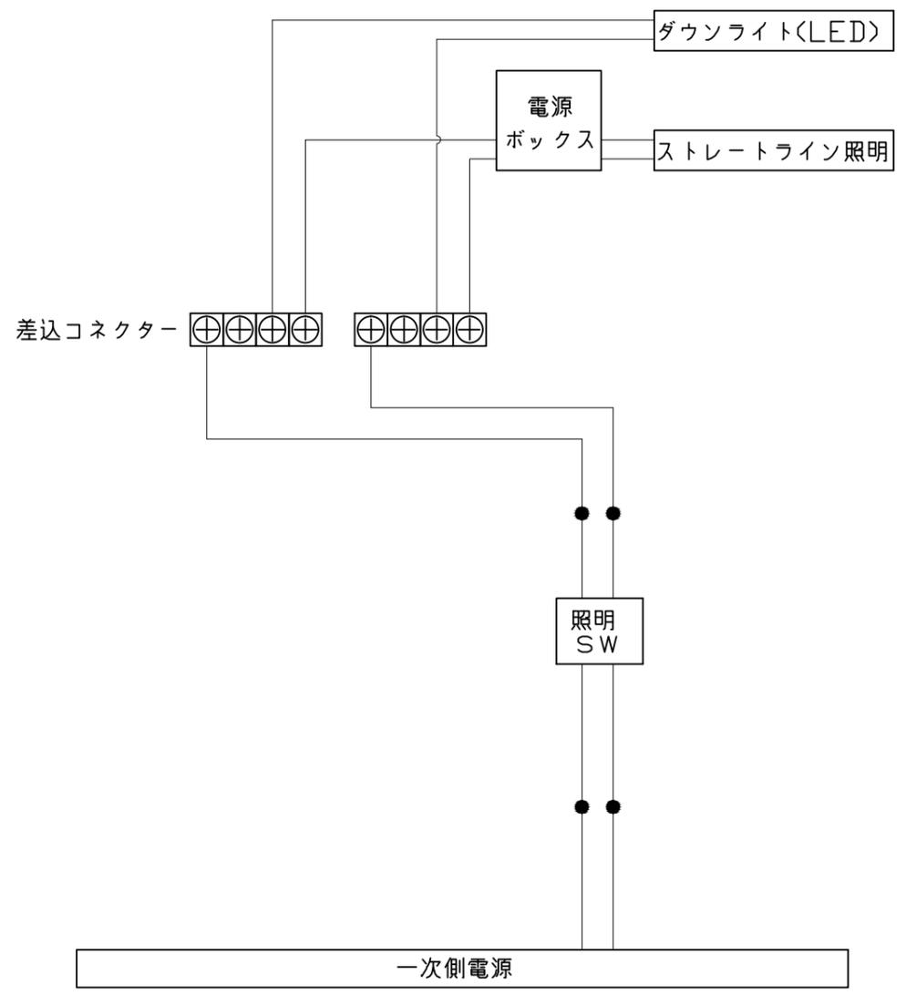
一次側電源から差し込みコネクター及び電源ボックスまでの工事(●部)については、電気設備に関する技術基準及び内線規定に基づき、指定工事業者(電気工事士)による施工が必要です。
