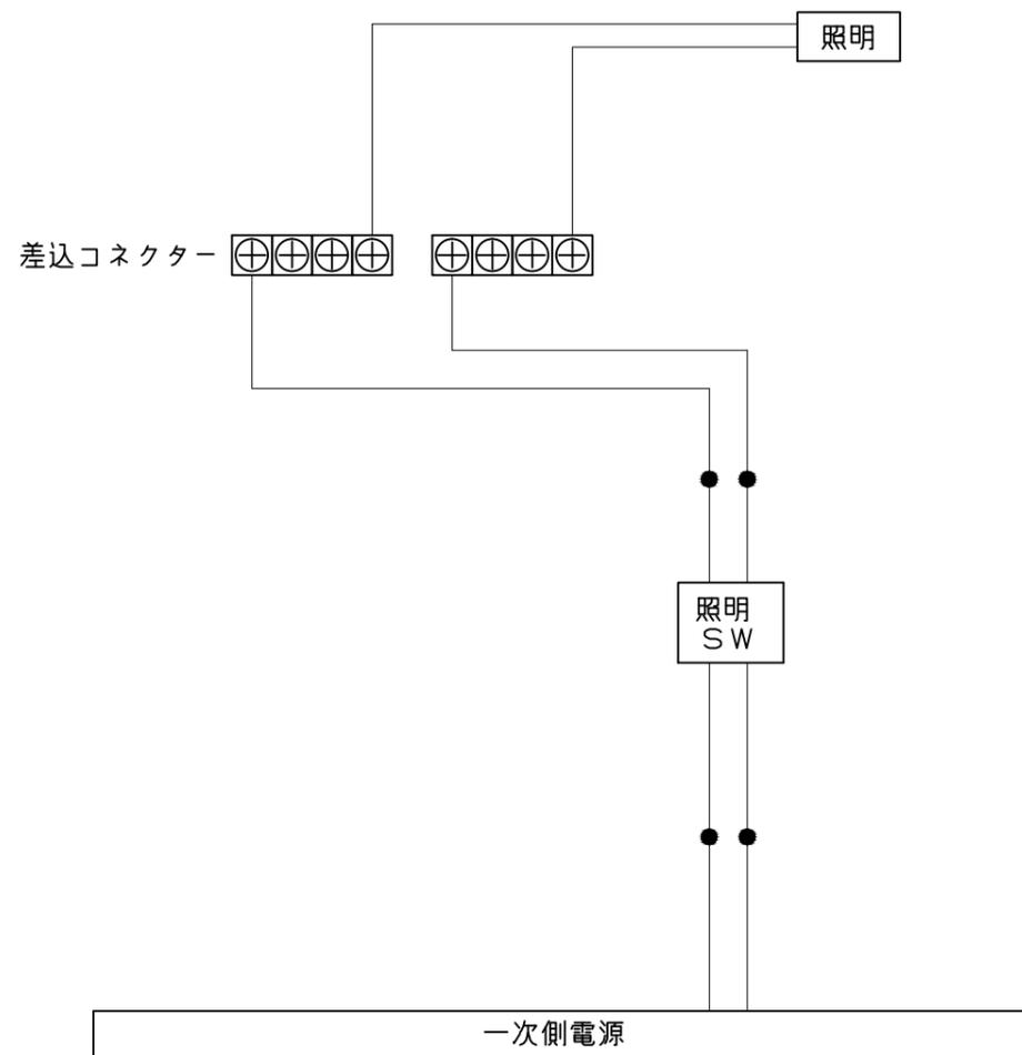
一次側電源から差し込みコネクター及び電源ボックスまでの工事(●部)については、電気設備に関する技術基準及び内線規定に基づき、指定工事業者(電気工事士)による施工が必要です。
