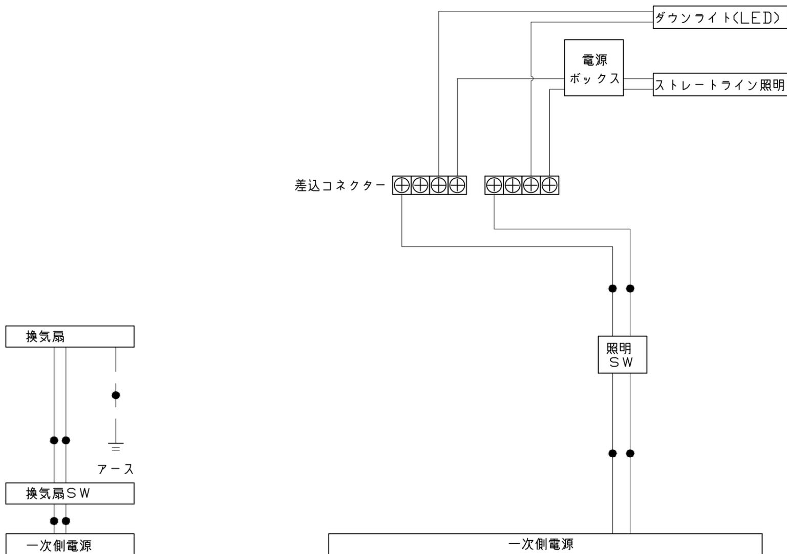
一次側電源から差し込みコネクター及び電源ボックスまでの工事(●部)については、電気設備に関する技術基準及び内線規定に基づき、指定工事業者(電気工事士)による施工が必要です。
