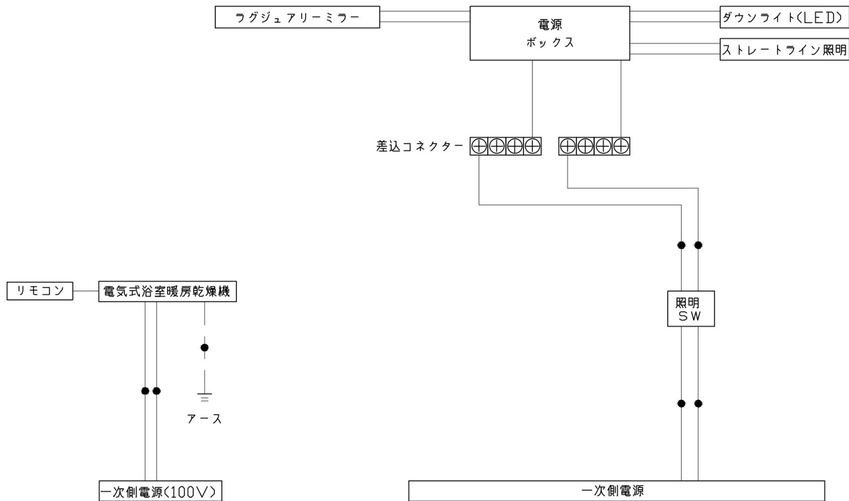
\*浴室暖房機の一次電源には専用のブレーカーを設けてください。
