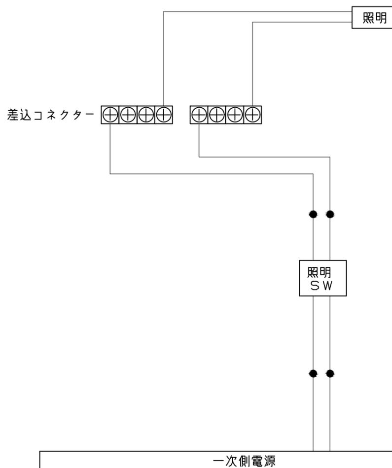
一次側電源から差し込みコネクター及び電源ボックスまでの工事(●部)については、電気設備に関する技術基準及び内線規定に基づき、指定工事業者(電気工事士)による施工が必要です。
