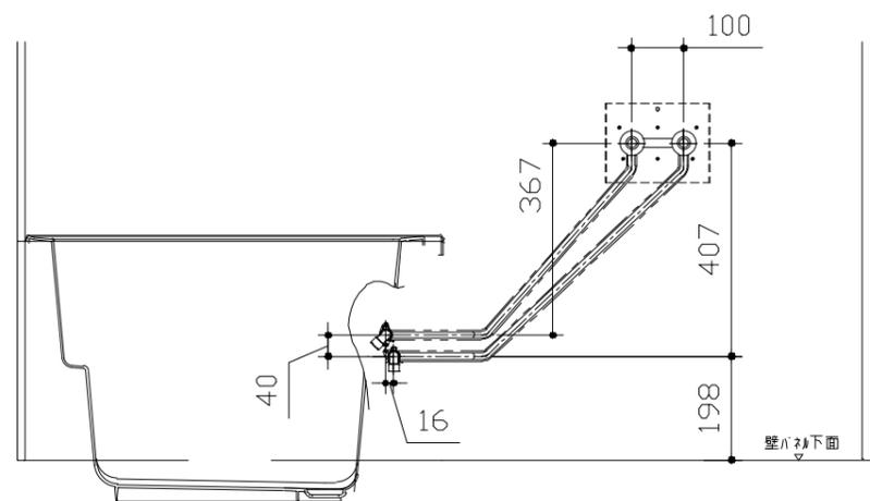
＜給水給湯管取合詳細図＞
