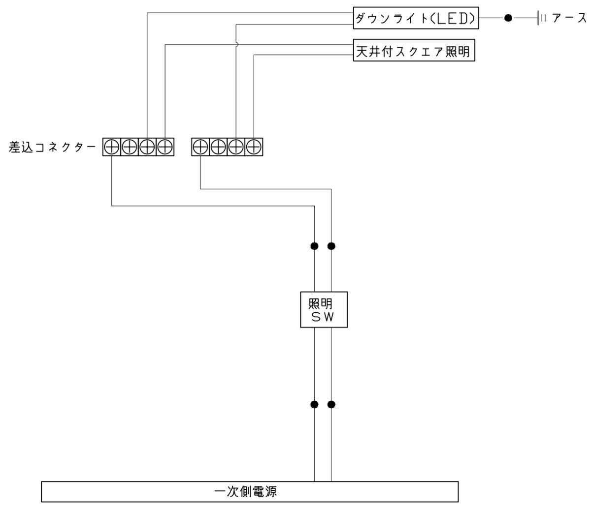
一次側電源から差し込みコネクタ及び電源ボックスまでの工事(●部)については、電気設備に関する技術基準及び内線規定に基づき、指定工事業者(電気工事士)による施工が必要です。
