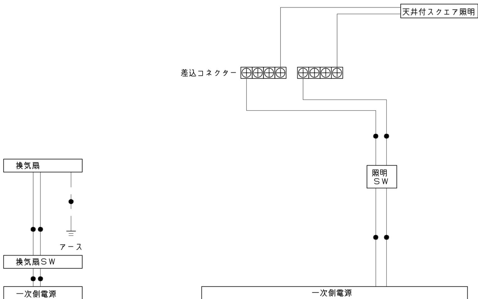
一次側電源から差し込みコネクター及び電源ボックスまでの工事(●部)については、電気設備に関する技術基準及び内線規定に基づき、指定工事業者(電気工事士)による施工が必要です。
