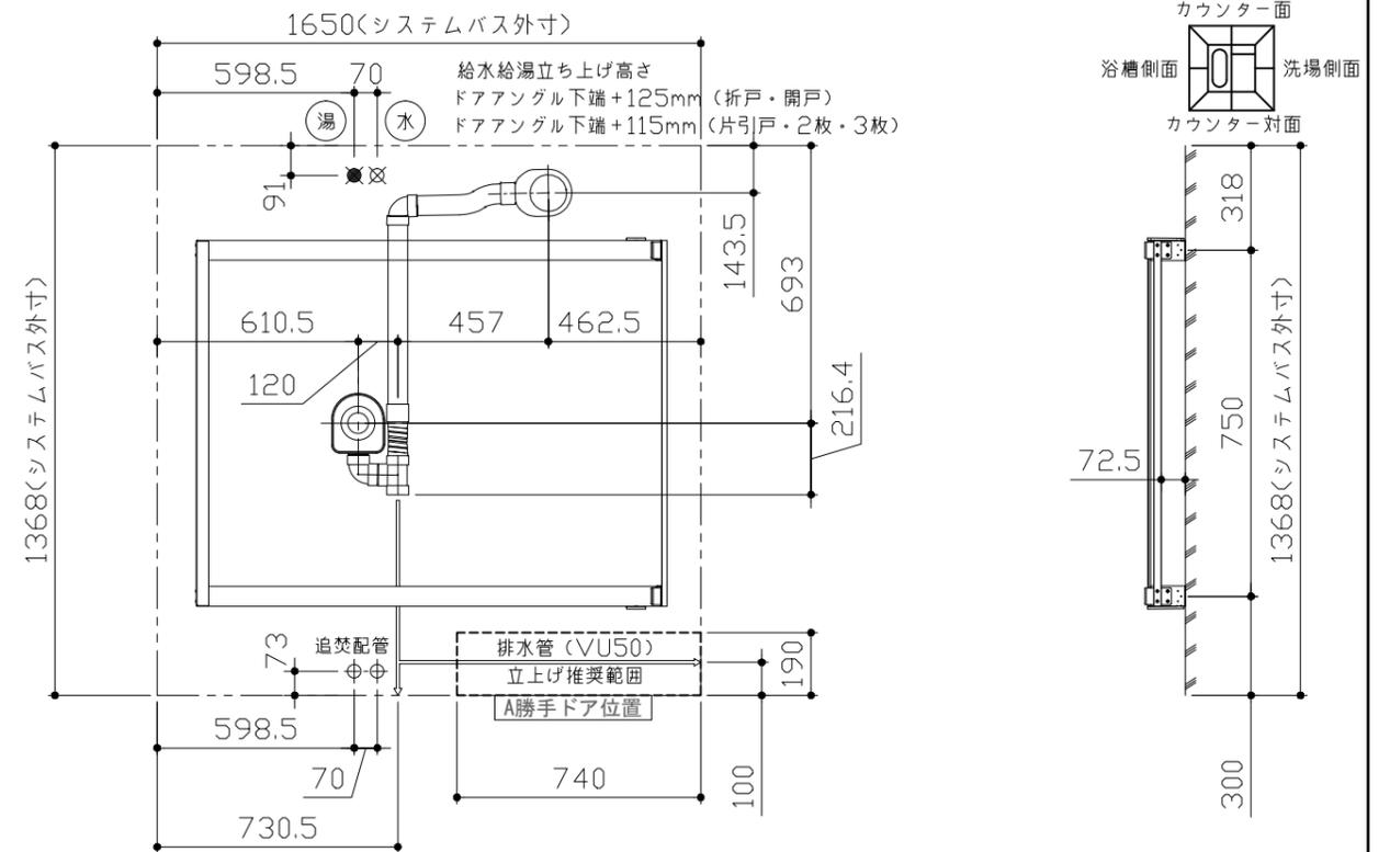
〈架台排水配管・給排水立上げ位置図〉
