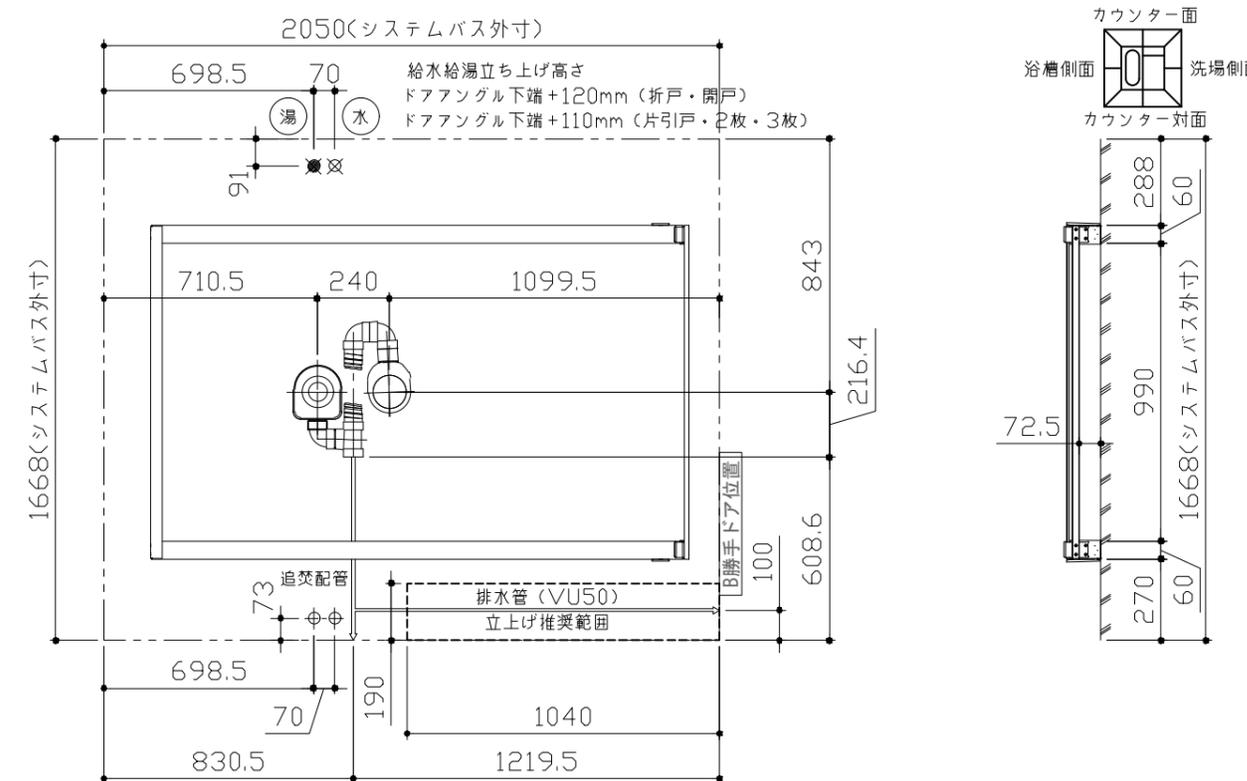
〈架台排水配管・給排水立上げ位置図〉
