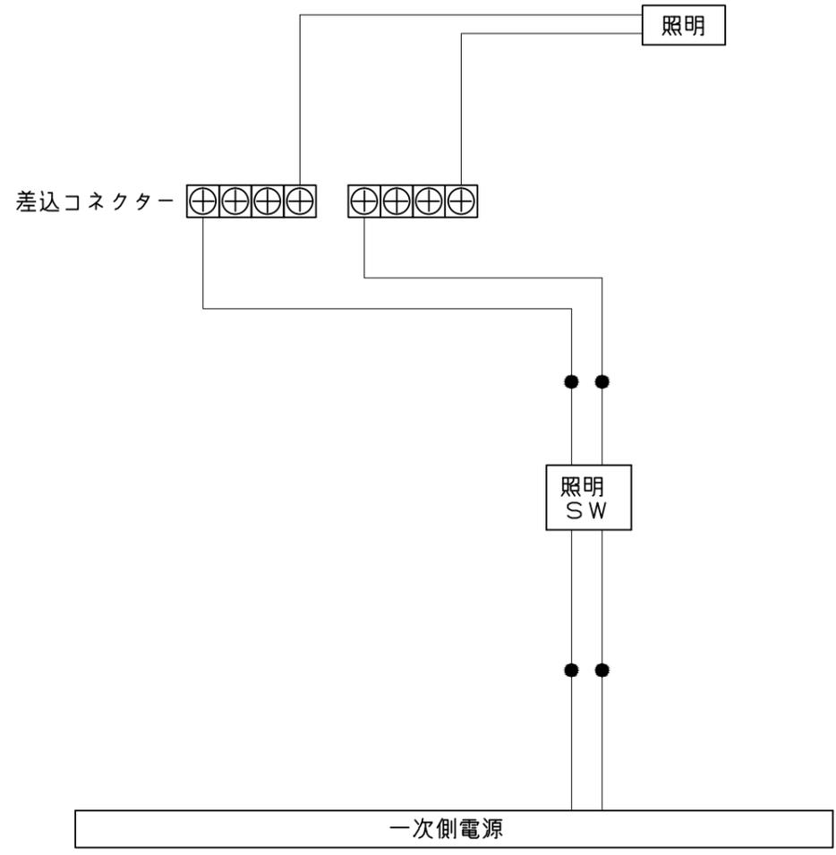
一次側電源から差し込みコネクター及び電源ボックスまでの工事(●部)については、電気設備に関する技術基準及び内線規定に基づき、指定工事業者(電気工事士)による施工が必要です。
