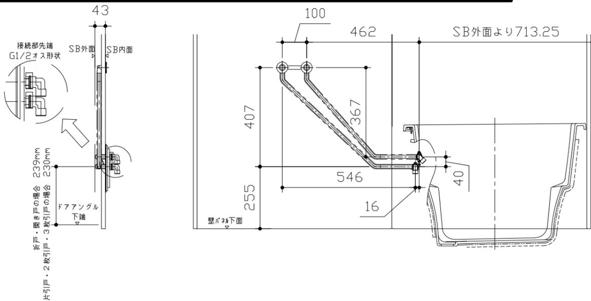
〈給水給湯管取合詳細図〉
