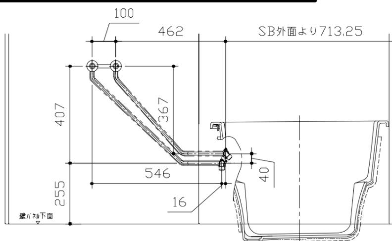
＜給水給湯管取合詳細図＞
