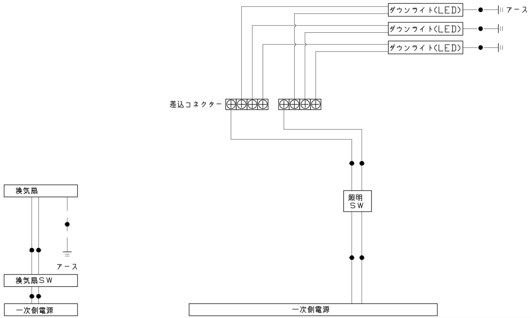
一次側電源から差し込みコネクタ及び電源ボックスまでの工事（●部）については、電気設備に関する技術基準及び内線規定に基づき、指定工事業者（電気工事士）による施工が必要です。
