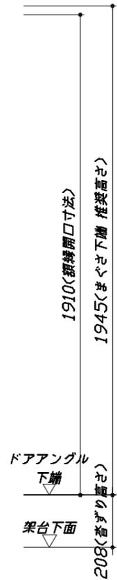
■ボルト脚架台高さ寸法
