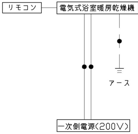
\*浴室暖房機の一次電源には専用のブレーカーを設けてください。
