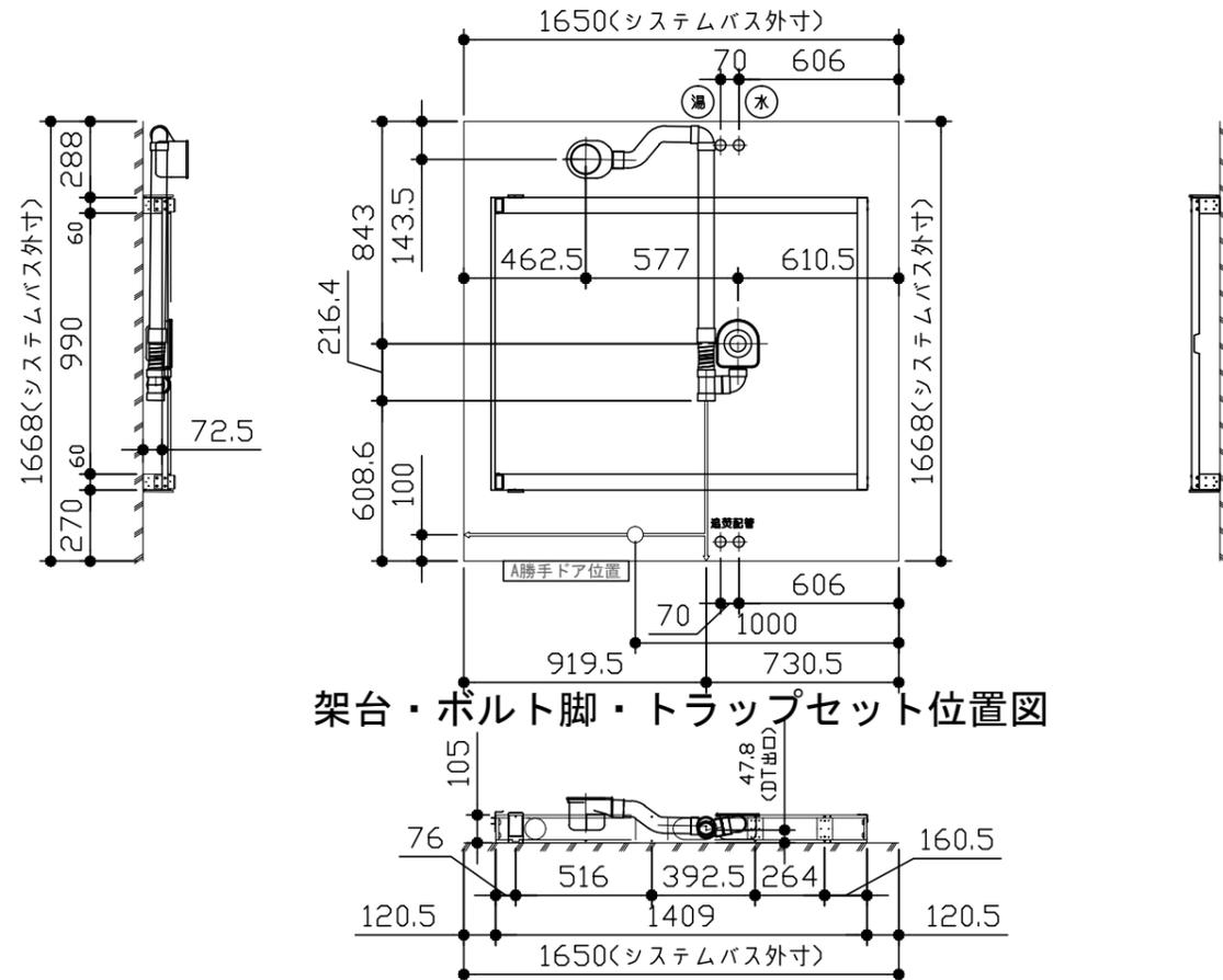
架台・ボルト脚・トラップセット位置図
