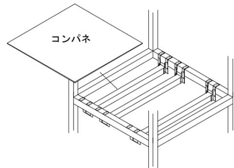
階上に設置する場合などは安全確保（落下防止）の観点よりコンパネを設置してください。
