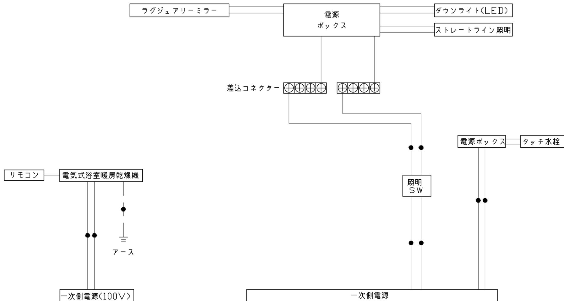
\*浴室暖房機の一次電源には専用のブレーカーを設けてください。
