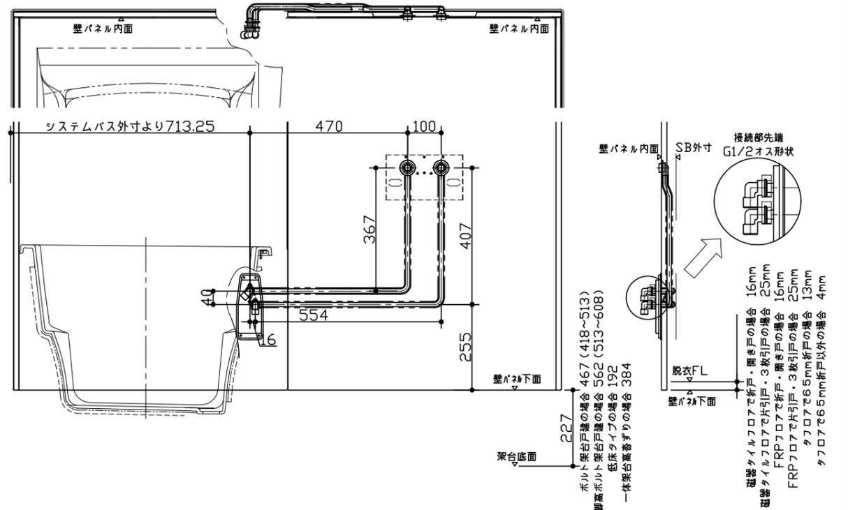
給水給湯管取合詳細図
