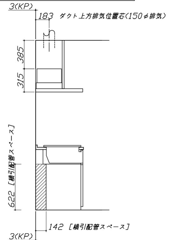
Zシンク給水排水配管例図
