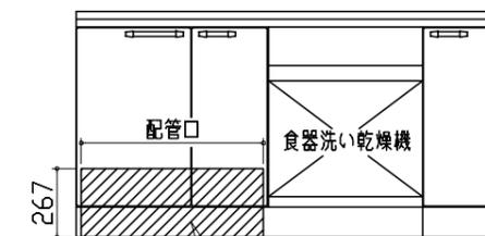
コンセント位置/配管口の下の後壁(15A-125Vアース端子付埋込)
