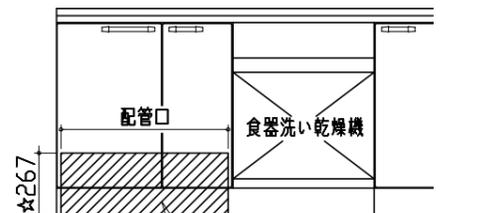
コンセント位置/配管口の下の後壁(15A-125Vアース端子付埋込)
