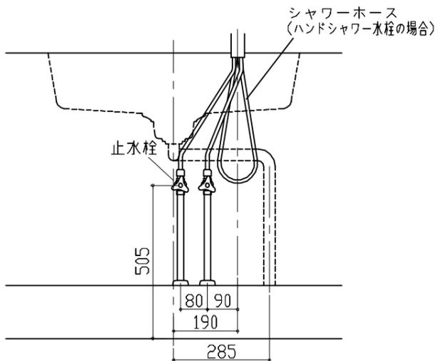
シンク下食器洗い乾燥機 配管例図
