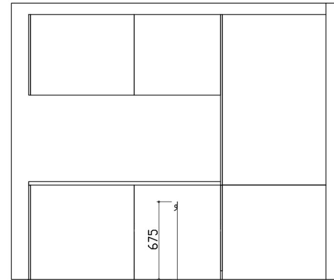
1291 家電収納ユニット用電源取出位置(100V・コード必要長さ1m)
