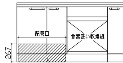
コンセント位置/配管口の下の後壁(15A-125Vアース端子付埋込)
