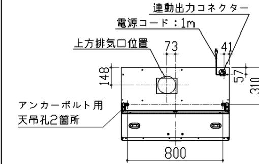
アルミダクト使用時の排気位置はダクト配管可能範囲を参照ください。直接排気の場合は、排気口の位置に内寸タテ160mm×ヨコ160mmで巾100mm以上の木枠を設けてください。実際の排気用接続部品の開口部寸法は、角の場合150mm×150mm、丸の場合φ148です。
