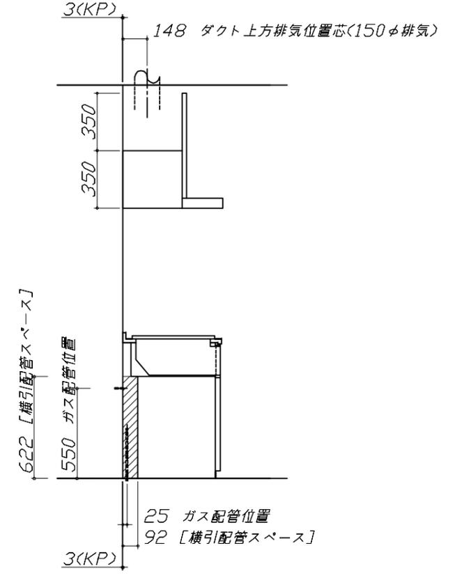
ZMシンク給水排水配管例図
